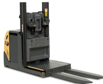
NOL10P, podnoszenie platformy na wysokość 1200 mm.
