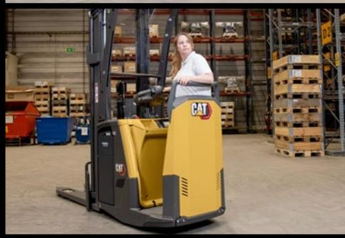
Os modelos com plataforma fixa oferecem proteção e conforto extras, com um degrau baixo para facilitar a entrada/saída e opções de concepção de barreiras de entrada traseira e lateral.
