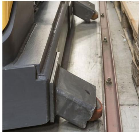
Draht- oder Schienenführung\* ermöglicht die schnelle Fahrt mit dem sicheren Anheben und Absenken der Last in Gängen, die nur wenig breiter sind als der Stapler selbst. Dank der schwenkbaren Schubmastgabel können Paletten auf beiden Gangseiten gehandhabt werden.
