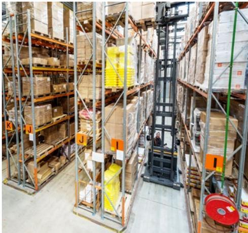
Bereitstellungsstapler sowie Aufnahme- und Ablagestationen an Gangenden entfallen, da unsere Hochregal-Schmalgangstaplermodelle sowohl den Transport als auch die Ein- und Auslagerung übernehmen können. Das erlaubt die Einsparung von Geräten, Personal und Zeit bei gleichzeitiger Gewinnung von Lagerraum.
