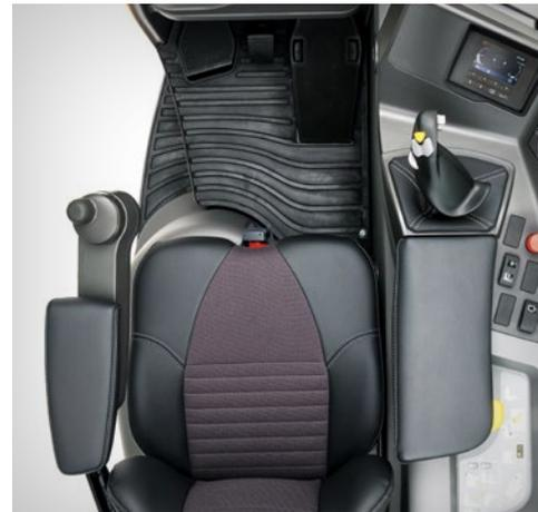
Die präzise Bedienung wird durch eine Handflächenlenkung (*Palm Steering*) und einen multifunktionalen Joystick gewährleistet. Zur perfekten Anpassung an den Bediener sind beide Armlehnen und die Bodenhöhe verstellbar. Der Sitz bietet eine entspannte Fahrhaltung und neigt sich gewichtsabhängig, um die Belastung des Bedieners beim Blick auf die angehobene Last zu mindern.
