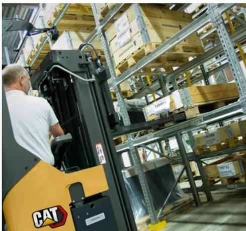
Bien qu'il soit spécialement adapté aux systèmes de rayonnage, ce chariot peut être utilisé de nombreuses manières. Comme manipuler de longues charges ou atteindre les zones de cargaison des camions. Il peut être utilisé comme un chariot à mât rétractable, un gerbeur à bras encadrants, un transpalette ou un préparateur de commandes.
