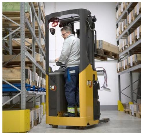
Plus compact et plus maniable qu'un gerbeur à plate-forme ou qu'un chariot à mât rétractable, il permet de se déplacer dans les allées étroites. Alors que ses systèmes hydrauliques, télescopiques, d'entraînement, de direction et de stabilité avancés rendent chaque opération plus rapide et plus fluide. Le résultat : meilleur usage de l'espace et cadences de travail de manutention plus élevées
