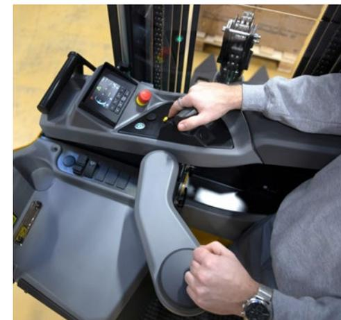
Les commandes ergonomiques améliorent encore le confort, la satisfaction au travail et la productivité, tout en évitant le stress, la tension et la fatigue. Elles incluent une console de direction entièrement réglable (haut/bas, avant/arrière) pour une position parfaite du conducteur, ainsi que des commandes montées sur l'accoudoir pour un contrôle simultané des fonctions de conduite et hydrauliques.
