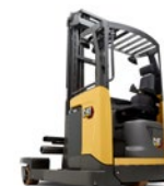
Electrostituitoare cu catarg retractabil cu patru direcții: capacitate 2,0 și 2,5 tone
