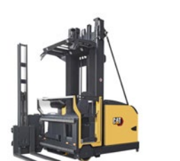
Motostivuitoare cu turelă man-up: capacitate 1,1 – 2,0 tone
