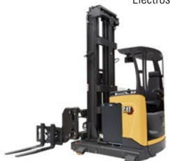
Motostivuitoare cu turelă man-down: capacitate 1,3 – 1,5 tone
