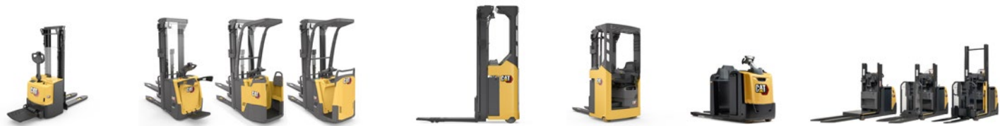
Wózki do niskiego składowania: udźwieg 1,0–2,0 tony
