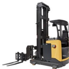
Hochregal-Schmalgangstapler: 1,3 – 1,5 Tonnen Tragkraft
