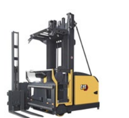
Man-up-Schubmaststapler: 1,1 – 2,0 Tonnen Tragkraft
