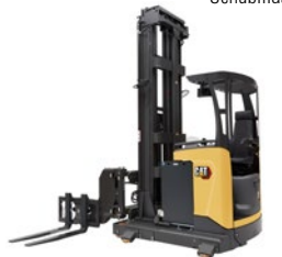
Hochregal-Schmalgangstapler: 1,3 – 1,5 Tonnen Tragkraft
