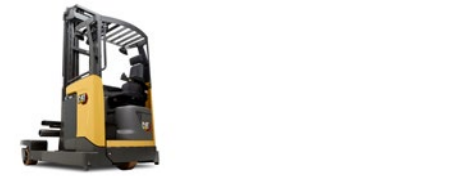
Vierwege-Schubmaststapler: 2,0 und 2,5 Tonnen Tragkraft
