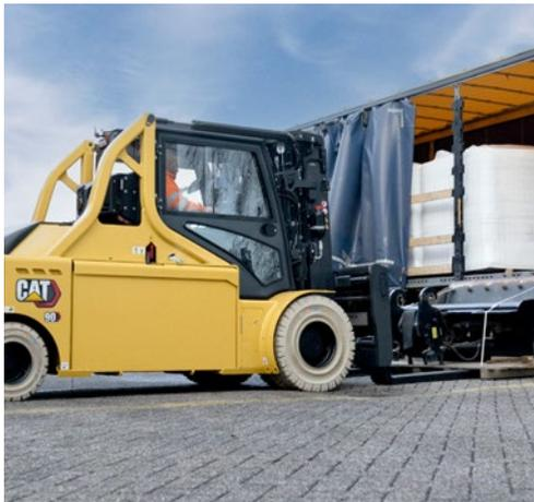
Les batteries grande capacité et les systèmes électriques écoénergétiques offrent un mélange idéal de performances et d'autonomie. Les batteries sont divisées en deux parties pour un remplacement facile par le côté à l'aide d'un transpalette ou d'un autre chariot élévateur à fourche. Les faibles besoins d'entretien et la durabilité des chariots face aux environnements difficiles réduisent encore les coûts et les temps d'immobilisation.
