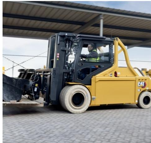
La technologie avancée du moteur et levage électriques offre toute la puissance et la vitesse que vous souhaitez. Le couple élevé, l'accélération et la force de levage se combinent à une commande électronique précise et à une grande souplesse d'utilisation. Les vérins d'inclinaison du mât sont positionnés à une hauteur élevée pour renforcer la stabilité et la capacité résiduelle.
