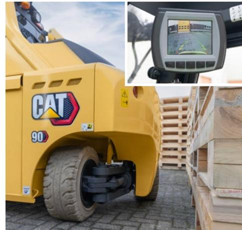
Les dimensions compactes du chariot et les angles de braquage élevés – y compris une rotation de l'essieu directeur de +100° sur les modèles NH – permettent une excellente maniabilité. Un protège-conducteur bas, disponible en option pour toutes les capacités de chariot, permet de pénétrer dans les conteneurs. Les manœuvres sûres et précises sont facilitées par une conception à vision claire et une caméra de recul.
